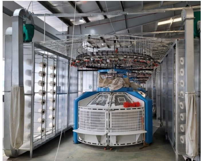
Hình 4.5: Hệ thống khung và bụi túi vải thu bụi từ máy dệt kim tròn
